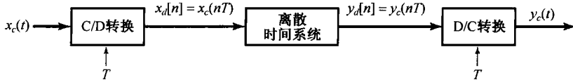
图 7.20 连续到离散时间转换和离散到连续时间转换的概念。 T 代表采样周期
